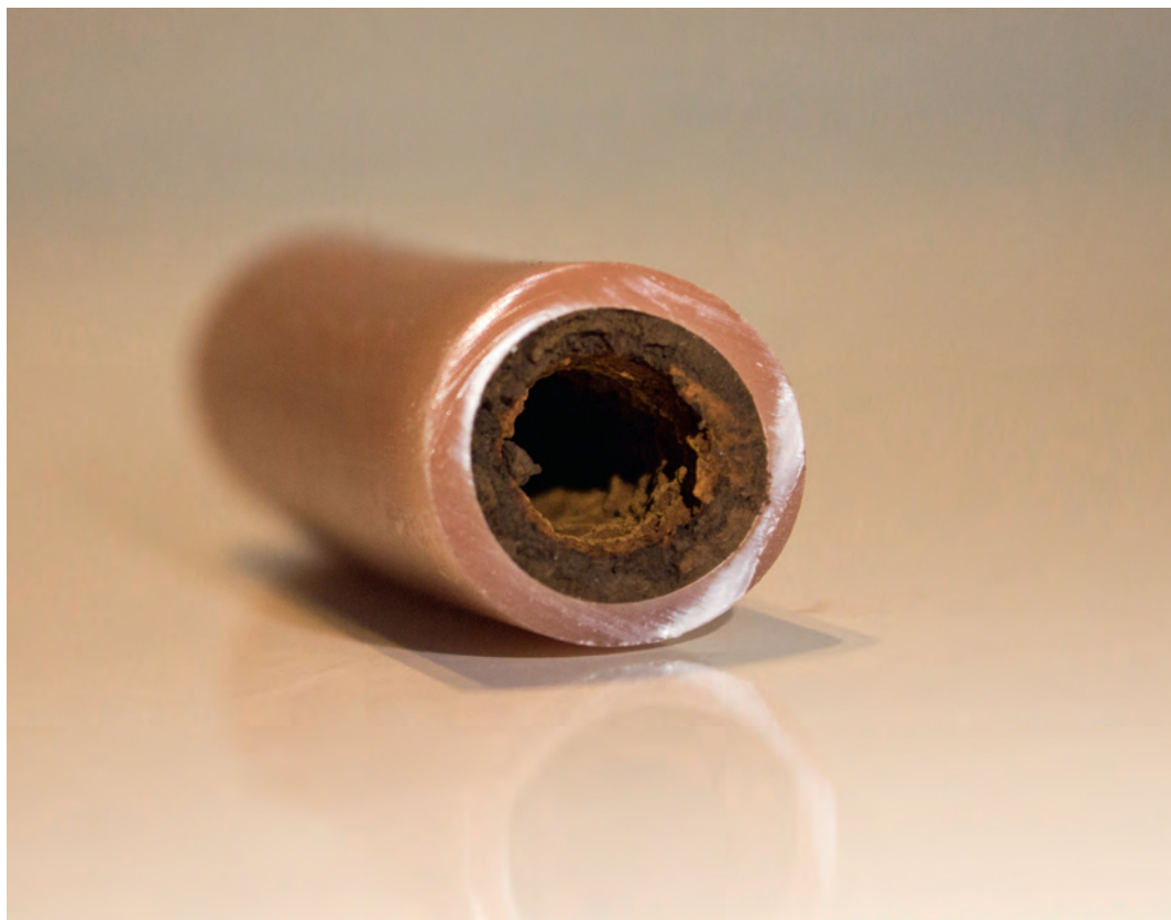
Tube en plastique encrassé et fragilisé d'un chauffage au sol.
