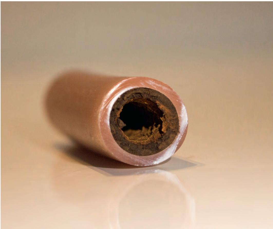
Verschlammtes und versprödetes Kunststoffrohr einer Bodenheizung.
